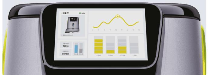
Um die Produktpalette von gewerblichen Servicerobotern in der Reinigungsbranche zu erweitern und mehrere Reinigungsszenarien abzudecken, hat Pudu Robotics den neuen Pudu CCI entwickelt, einen Reinigungsroboter für den geschäftlichen Einsatz, der folgende Funktionen bietet: Schrubben, Kehren, Wischen und Staubsaugen, automatisches Aufladen, automatisches Auffüllen oder Ablassen von Wasser und digitale Reinigung.
